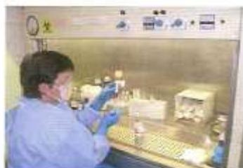
koji radi na principu usisavanja i filtriranja zraka kontaminiranog citostatičnim česticama (parama, aerosolima) koje se oslobađaju na radnoj površini, a nakon korištenja ima mogućnost steriliziranja UV svjetlošću.
